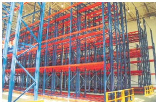
СКЛАДОВА СИСТЕМА С ДВОЙНА ДЪЛБОЧИНА DOUBLE DEEPTH WAREHOUSE
